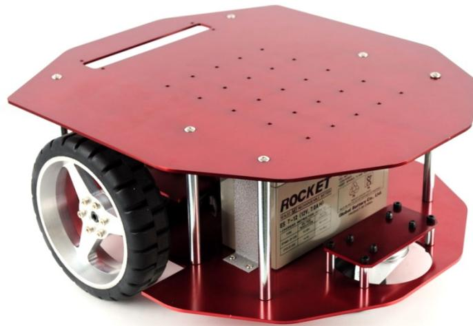
NTREX의 StellaB3로봇은 2륜 차동 구동(Two wheel differential drive) 방식으로 전방에 두 개의 구동 바퀴를 가지고 뒷 부분에 캐스터를 가지는 아주 단순한 구조를 가지는 로봇입니다. 이러한 로봇은 주로 바닥이 평평한 실내에서 운행하는 용도로 만들어집니다.
